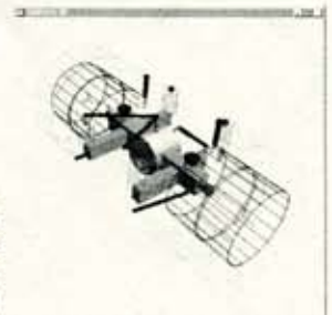
Parametrierte Substruktur für eine Nutzfahrzeugachse mit Längs- und Dreieckslenkern
