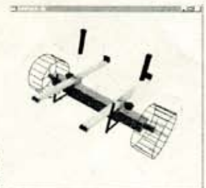
Parametrierte Substruktur für eine Nutzfahrzeugachse mit Blattfedern
