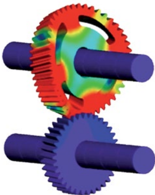
Fig 2: Critical gear eigenmode
