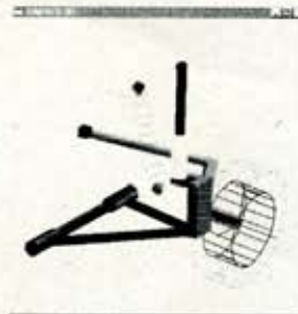
Mc-Pherson-Achse (optional mit Querlenkern als Einzelkörper)
